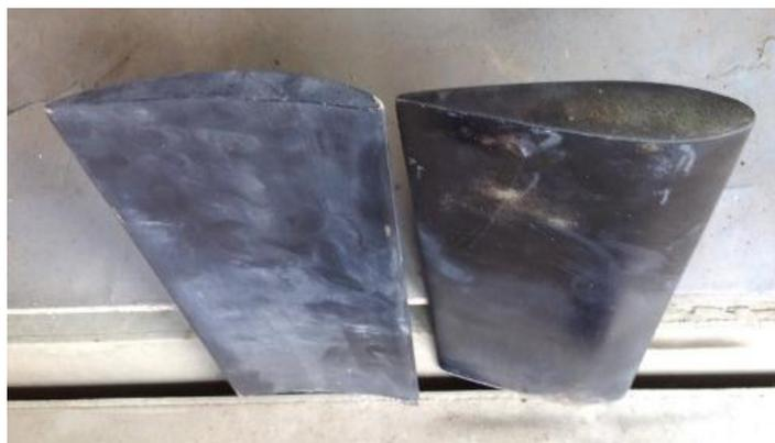
Gambar 3-6 Foto sayap dengan airfoil NACA0015 dan Brisith 9C7
