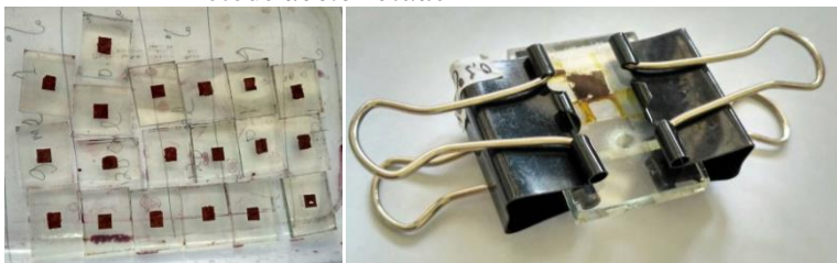
Gambar 3.12 Pelapisan foto anoda pada kaca FTO menggunakan metode doctor blade
