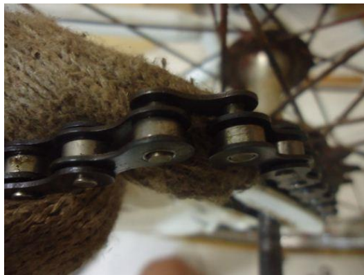
Gambar 2.20 Pelepasan penghubung rantai
