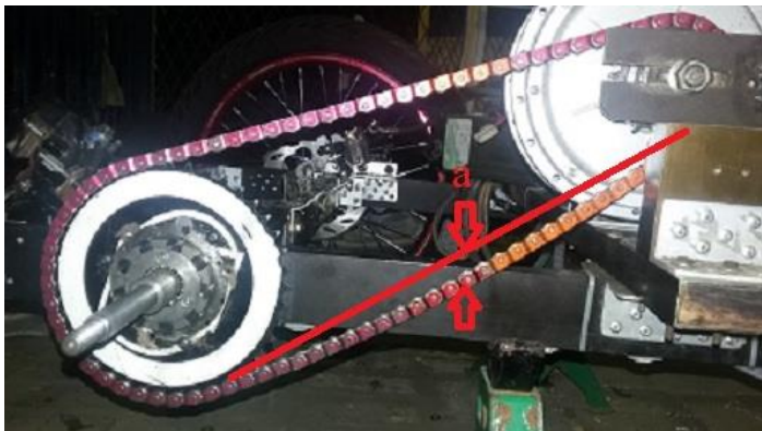
Gambar 4.7 Jarak kekenduran pada rantai Nogogeni
