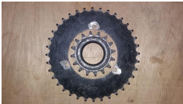
Gambar 3.4 Sprocket mobil Nogogeni
