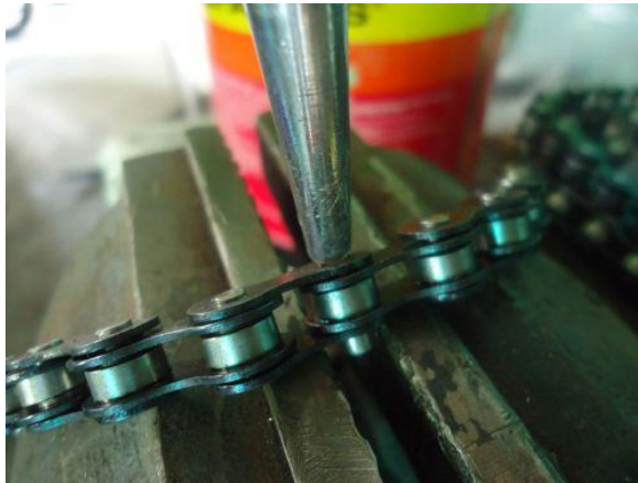
Gambar 2.22 Pelepasan pin rantai
