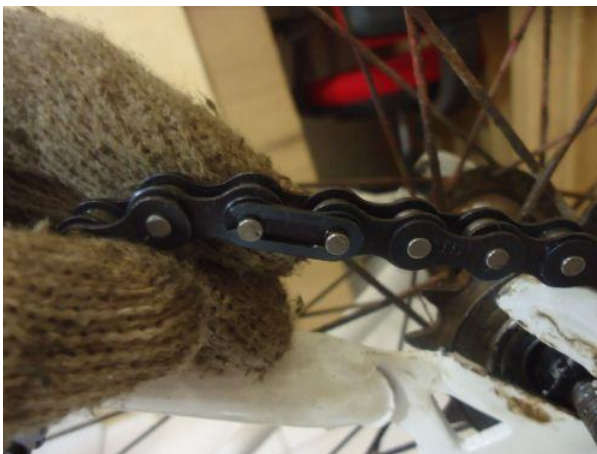
Gambar 2.24 Pemasangan penghubung dan pen rantai.
