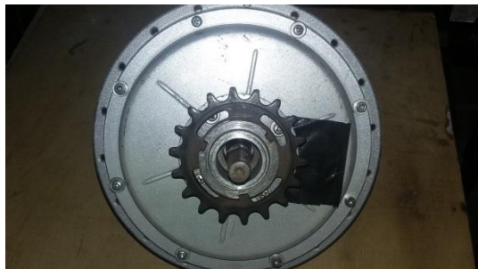
Gambar 3.2 Motor penggerak mobil Nogogeni
