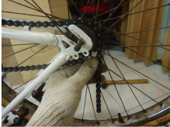
Gambar 2.21 Pengukuran panjang rantai
