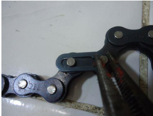
Gambar 2.19 Pelepasan pengunci rantai
