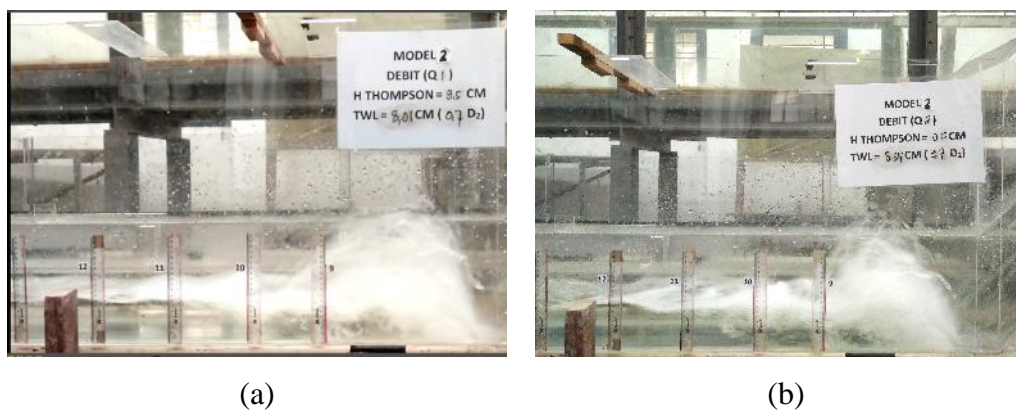
Gambar 4.33 Kondisi Loncatan Air pada Kolam Olak Model Seri 2 untuk TW\ depth = 0,7 D_2 pada (a) Debit Q 1 ; (b) Debit Q 2
