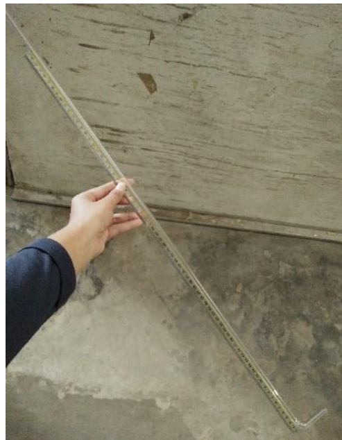
Gambar 3.3 Alat Pengukur Kecepatan berupa Tabung Pitot (Dokumentasi Pribadi)
