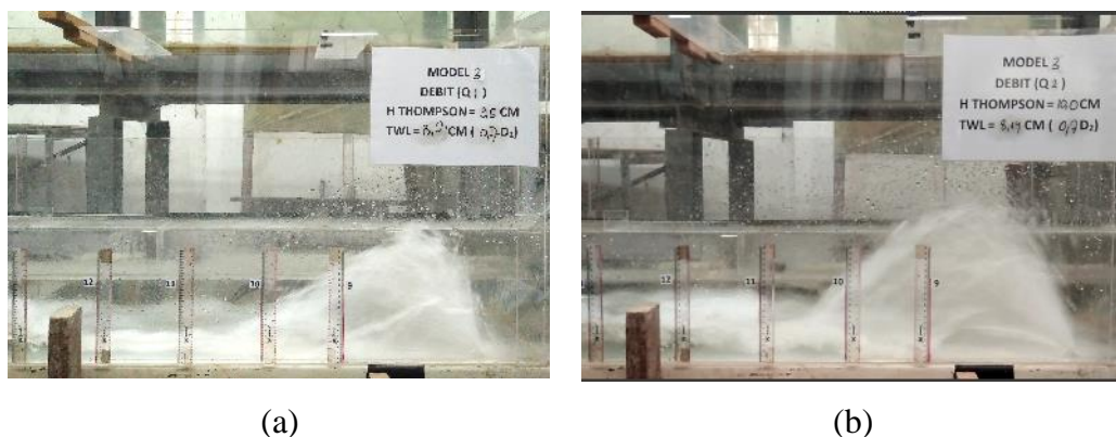
Gambar 4.37 Kondisi Loncatan Air pada Kolam Olak Model Seri 3 untuk TW depth = 0,7 D 2 pada (a) Debit Q 1 ; (b) Debit Q 2
