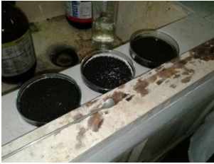
Gambar L1.5. Perendaman Arang Batok Kelapa dalam Pengujian Ketahanan Fisik Arang Batok Kelapa
