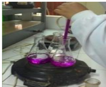
Gambar L1.16. Analisis Permanganat Value pada Sampel Air Limbah
