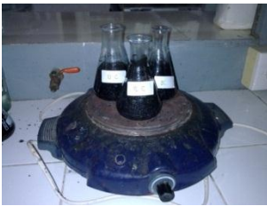
Gambar L1.7. Pengujian Densitas Arang Batok Kelapa Menggunakan Metode True Bulk Density
