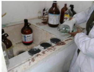
Gambar L1.4. Penambahan Larutan HCl 20% dalam Pengujian Ketahanan Fisik Arang Batok Kelapa
