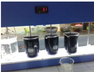
Gambar L1.15. Analisis Adsorpsi Sistem Batch Menggunakan Jartest
