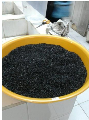
Gambar L1.8. Arang Batok Kelapa Setelah Diaktivasi Menggunakan Larutan HCl 20% dan dicuci menggunakan Larutan Aquades Serta Ditiriskan
