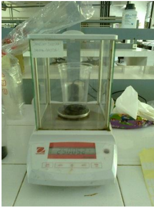
Gambar L1.13. Penimbangan Adsorben 25 gram untuk Analisis Adsorpsi Sistem Batch Menggunakan Jartest
