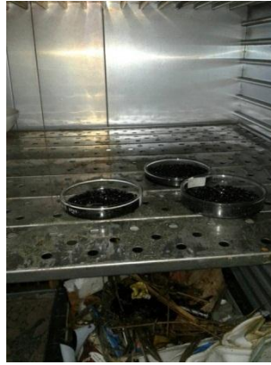
Gambar L1.6. Pengovenan Arang Batok Kelapa dalam Pengujian Ketahanan Fisik Arang Batok Kelapa
