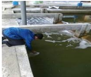
Gambar L1.12. Pengambilan Sampel Air Effluent pada IPAL Industri Pertambangan Iodium
