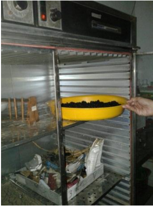
Gambar L1.9. Pengeringan Arang Batok Kelapa Menggunakan Oven Setelah Diaktivasi dan Dicuci Serta Ditiriskan
