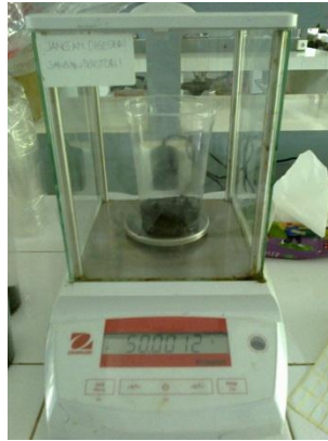
Gambar L1.14. Penimbangan Adsorben 50 gram untuk Analisis Adsorpsi Sistem Batch Menggunakan Jartest
