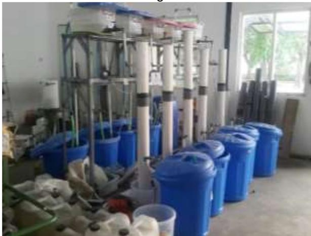
Tampak samping reaktor SSF yang terletak didalam ruangan
