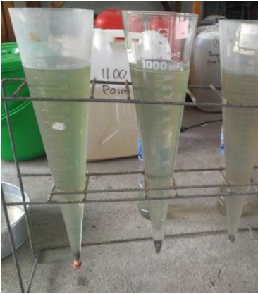
Gambar L. 6 Pengukuran Endapan Lumpur dengan Imhoffcone
