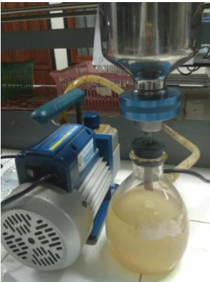
Gambar L. 7 Penyaringan Total suspended solid dengan Vacuum Pump
