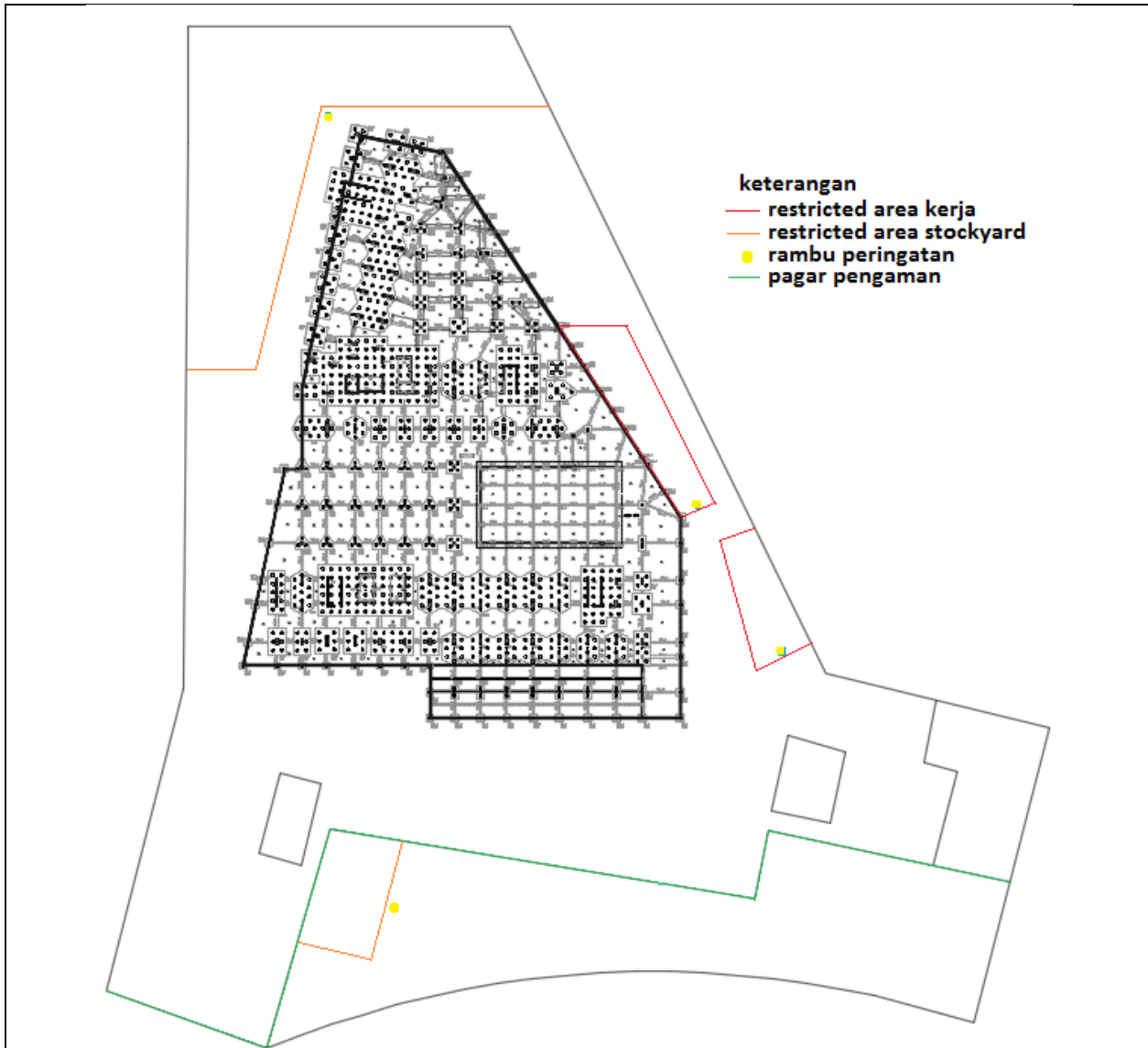
Gambar 4. 1 Restricted Area dan Pembatas Area Kerja Gunawangsa Tidar Apartement
