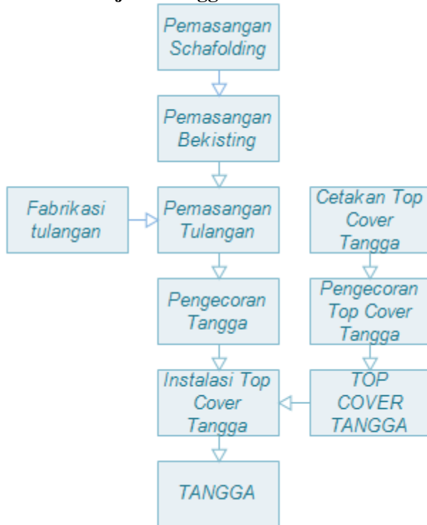
Gambar 4. 54 Urutan Metode Pekerjaan Tangga
