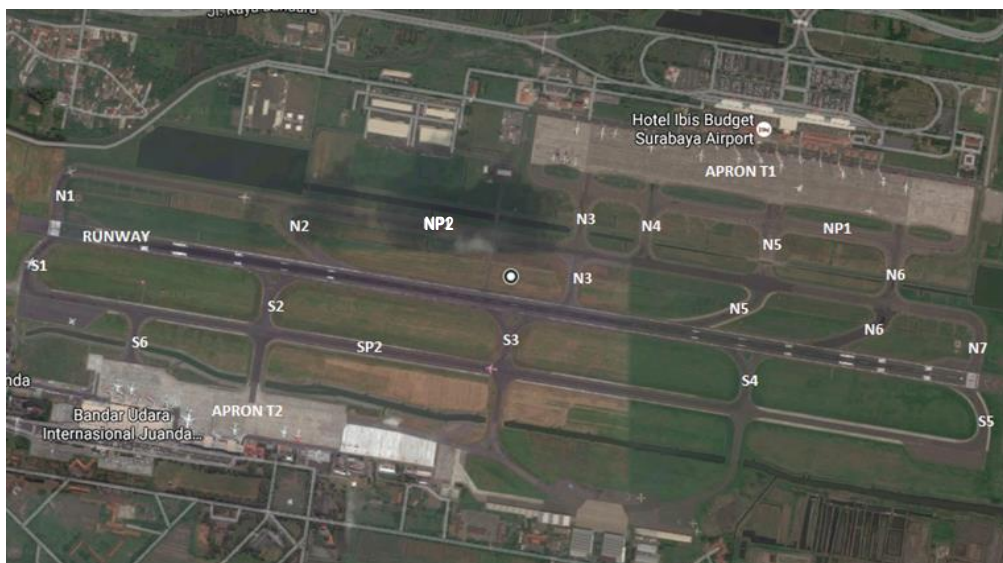
Gambar 1.1 Layout fasilitas sisi udara Bandar Udara Juanda
