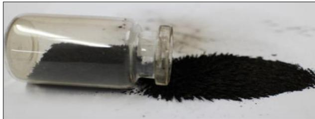
Gambar 4.1 Bentuk Magnetite Hasil Sintesis.
