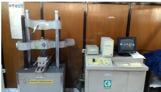
**Gambar 3.10** Mesin Uji Tarik
