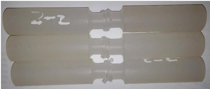
**Gambar 4.13** Sambungan hasil *friction welding* dengan tekanan gesek 56,265 Kgf/cm<sup>2</sup>
