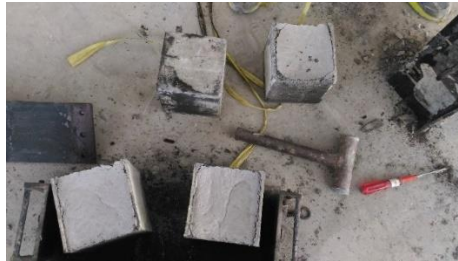
Benda Uji Pasir Silika Densitas Rencana 500 \text{ Kg/cm}^3
