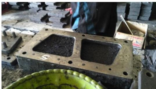
**Gambar 3. 4 Cetakan kampas rem yang sebagian telah terisi**
