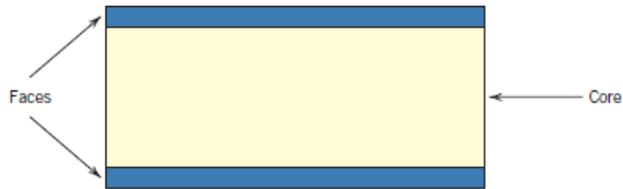
**Gambar 2. 6** Struktur *Sandwich panel*
