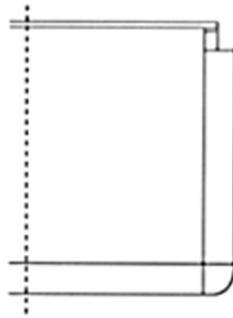
Gambar 2-5 Konstruksi Melintang Kapal Bulk carrier ( Open Hatch )
