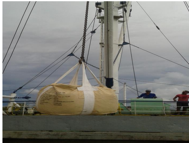
Gambar 5-3 Proses Pemuatan Ferronikel Bag dengan menggunakan sling dan crane kapal
