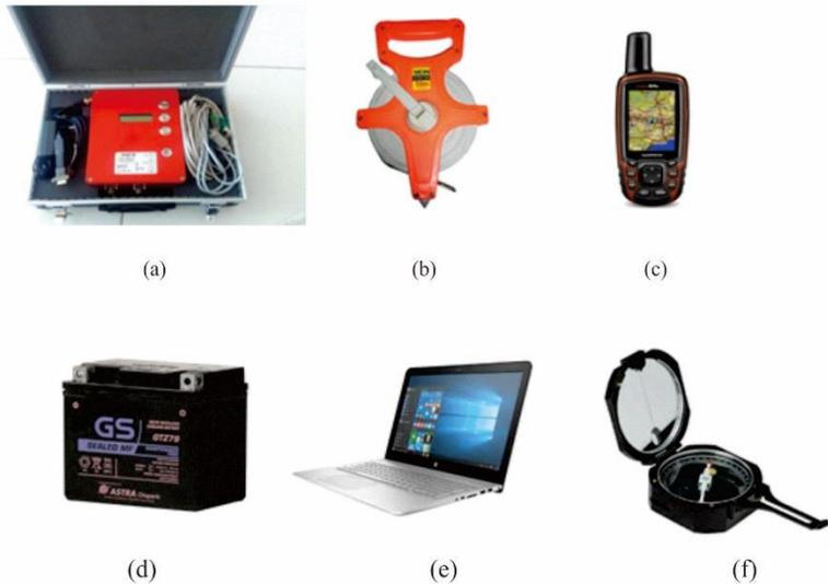
**Gambar 3.1** Daftar peralatan penelitian (a) 1 set Mikrotremor, (b) Meteran, (c) GPS, (d) Baterai, (e) Laptop, dan (f) Kompas
