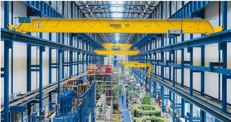
Gambar 2. 3 *Overhead crane single girder* dengan SWL 10 Ton
