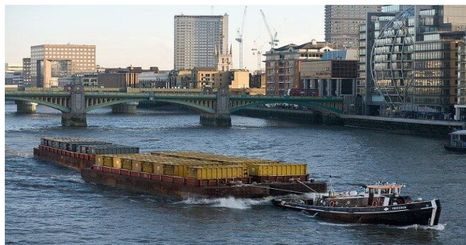
Gambar 2 - 3. Kombinasi Kapal Tunda Yang Menarik Tongkang.
