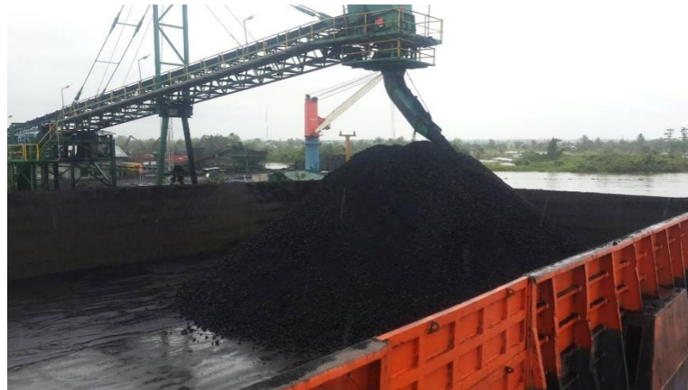
Gambar 4 - 10. Proses Pemuatan Batubara di atas Tongkang.
