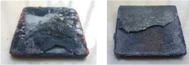
Gambar 4.4 Permukaan spesimen tanpa pelapisan setelah mengalami siklus uji thermal
