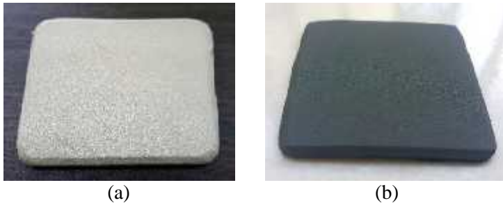
Gambar 4.5 Permukaan spesimen ( \text{Cr}_3\text{C}_2\text{-20NiCr} ) (a) Sebelum mengalami siklus uji termal, (b) Setelah mengalami siklus uji termal
