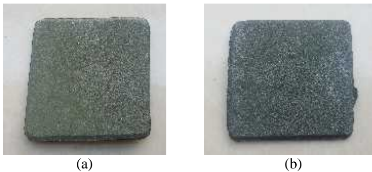
Gambar 4.6 (a) Permukaan spesimen (NiCrBSi-40SiC), (b) Spesimen (NiCrBSi-40WC-Co) setelah mengalami siklus uji termal
