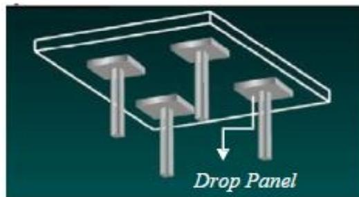
**Gambar 2.6** Struktur Flat Slab (FEMA 356)
