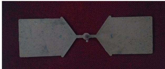
Gambar 4.7 Hasil uji coba injeksi material biokomposit campuran PP dan sekam padi
