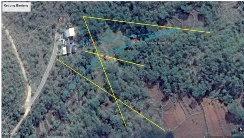
Gambar 4. 19 Arah aliran sungai bawah permukaan kawasan Kedung Banteng dilihat dari atas dengan orientasi Timur Laut – Barat Daya.
