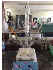
Proses refluks (Setelah penambahan H_2SO_4 1,25%)
