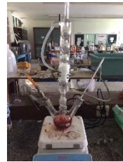
Proses refluks (Setelah penambahan NaOH 3,25%)
