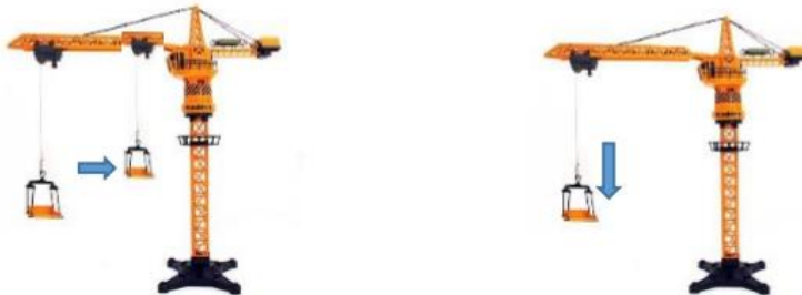
Gambar 10 Proses Trolley (jalan) dan proses Landing (penurunan)
