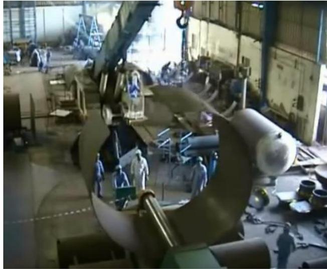
Gambar 5.15. Proses *Rolling Pelat* Menggunakan *Bending Machine*
