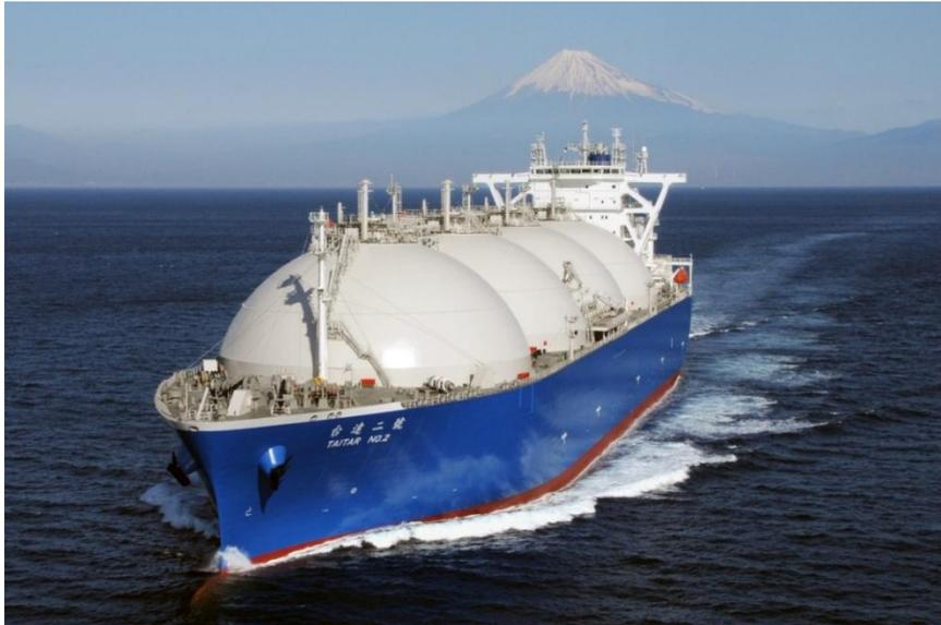
Gambar 2.20. LNG Carrier dengan *Spherical Tanks* (Moss)
