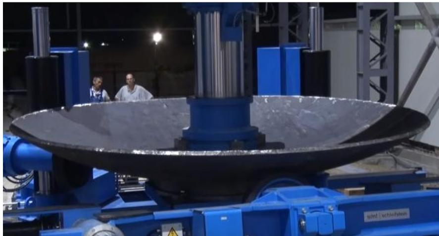
Gambar 5.16. Proses Pembentukan *Spherical Dish*
