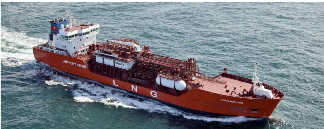
Gambar 2.15. *Small Scale LNG Carrier* 7.500 m<sup>3</sup>
