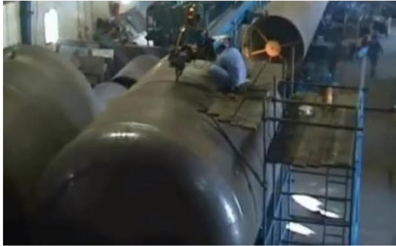
Gambar 5.17. Proses Pengelasan antar Bagian Tangki Menggunakan SAW
