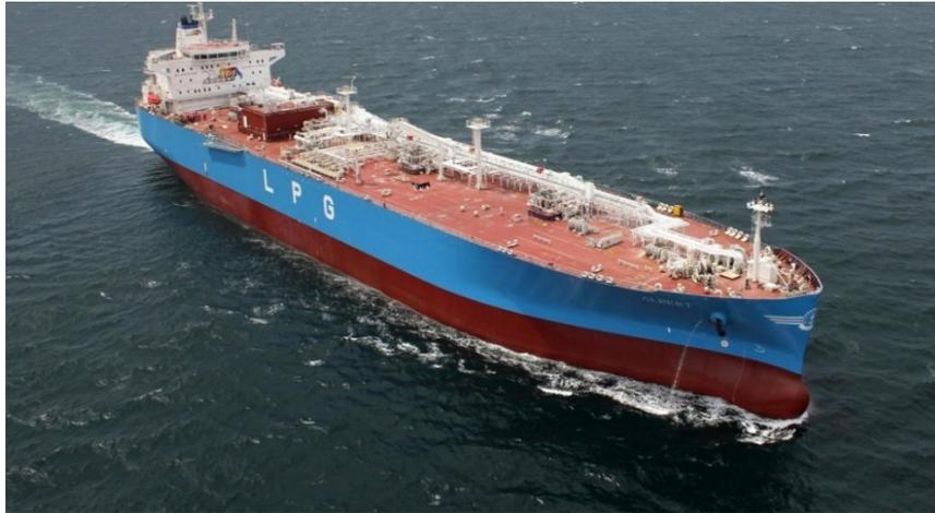
Gambar 2.17. *LPG Carrier* dengan *Prismatic Tanks*
