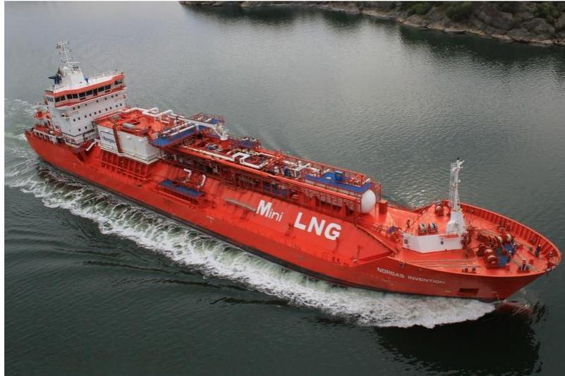
Gambar 2.26. *Small Scale LNG Carrier dengan Cylindrical Tanks*
