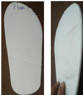
Gambar 4.15 hasil cutting dengan pressure 7 bar
