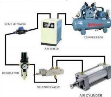
Gambar 2.9 Sistem Pneumatik
