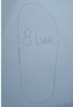
Gambar 4.18 Sket gambar hasil cutting dengan pressure 8 bar
