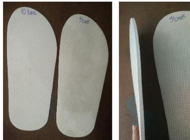
Gambar 4.19 Hasil cutting dengan pressure 9 bar dan 10 bar
