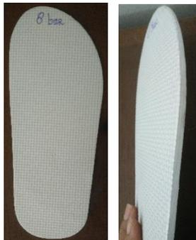
Gambar 4.17 Hasil cutting dengan pressure 8 bar
