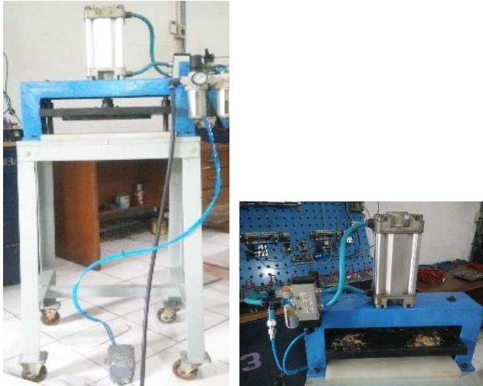
Gambar 4.11 Foto Mesin Pemotong Sandal Hotel Sistem Pneumatik
