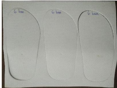
Gambar 4.14 Hasil cutting dengan pressure 6 bar
