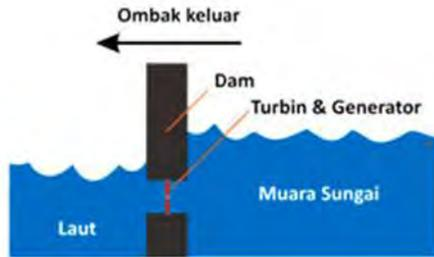
Gambar 2.1.2 Skema Kerja Tidal Energy [10]
