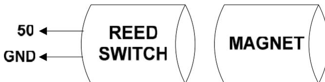
Gambar 4.22 konfigurasi sensor reed switch (up-limit) yang tersambung pada Pin *board* Arduino Mega
