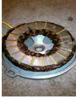
Gambar 2.8 Core pada Axial BLDC Motor ( www.endless-sphere.com )
