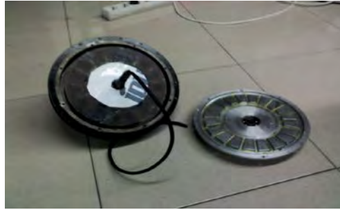
Gambar 2.14 Stator dan Rotor Axial coreless Brushless yang diassembly (Tugas Akhir Hudha Rencana)
