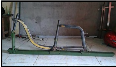
Gambar 6.6 rangka sepeda yang telah jadi setelah proses pengelasan
