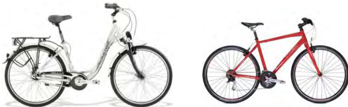
Gambar 2.2 Sepeda wanita (kiri) dengan top tube rendah sedangkan sepeda pria (kanan) dengan top tube tinggi
