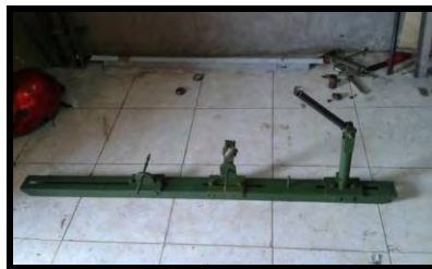
Gambar 6.2 Jig & fixture sepeda yang digunakan selama proses perakitan.
