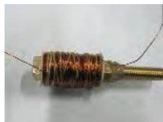
Gambar 4.6 Elektromagnet yang digunakan sebagai penggerak
