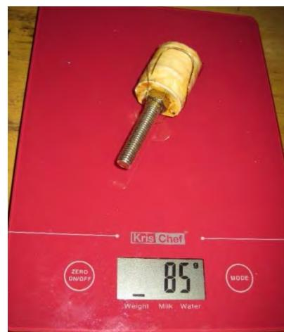
Gambar 4.21 Pengukuran massa solenoid besar yang digunakan sebagai beban (85 gram)
