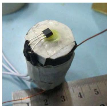
Gambar 4.25 Peletakan sensor *hall effect* pada ujung inti elektromagnet.
