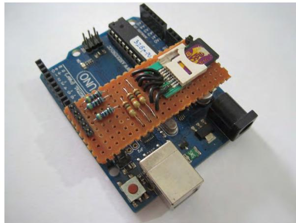
Gambar 3.21 Arduino sebagai *datalogger* dengan *SD card shield*
