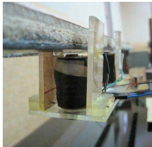
Gambar 4.31 Kereta berhasil melayang dengan elektromagnet bertegangan 24 volt.
