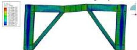
Gambar IV.48 Kontur Tegangan EBF-I Step-1
