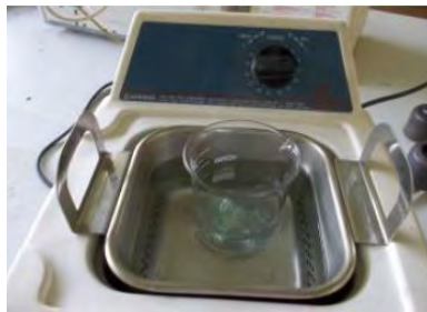
Gambar 3.2 Pembersihan kaca ITO menggunakan ultrasonic cleaner
