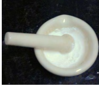
Gambar 3.3 Pembuatan pasta \text{TiO}_2 menggunakan mortar
