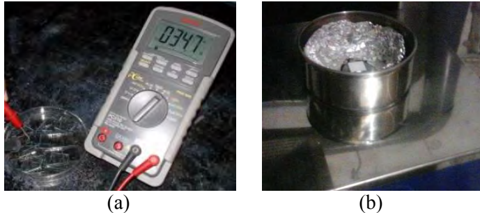
Gambar 3.4 (a) Pengetesan sisi konduktif dari kaca ITO (b) pelapisan \text{TiO}_2 menggunakan metode spin coating
