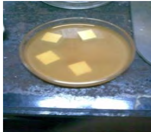
Gambar 3.9 Kaca yang sudah dilapisi larutan TiO 2 direndam dalam larutan dye
