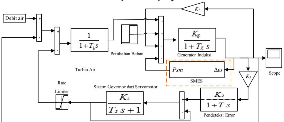
**Gambar 3.9a** Diagram blok pembangkit mikro hidro dengan SMES
