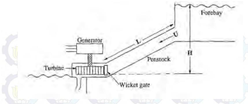
**Gambar 2.2** Skema turbin pada pembangkit listrik tenaga hidro
