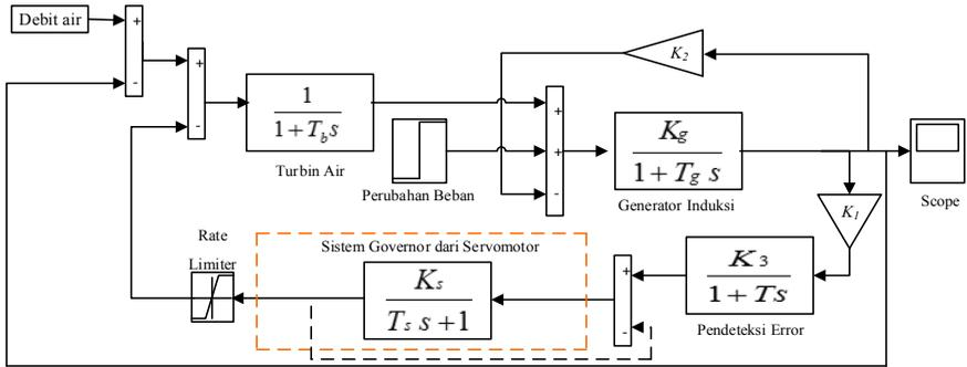
**Gambar 3.2** Diagram blok sistem pembangkit listrik tenaga mikro hidro
