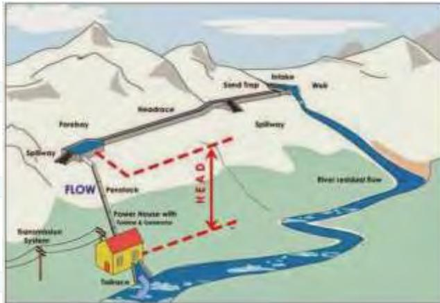
**Gambar 2.8** Tampilan umum pembangkit listrik mikro hidro
