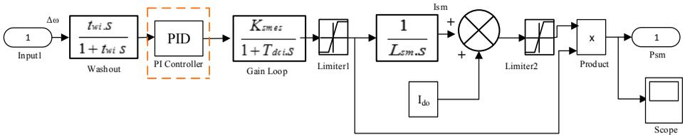
**Gambar 3.10b** Diagram blok *controller* SMES yang dilengkapi dengan *controller* PI
