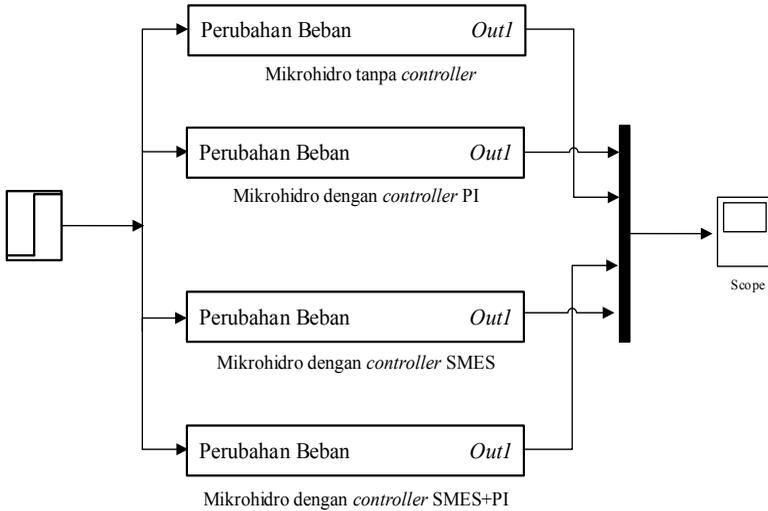
**Gambar 3.6** Blok diagram perbandingan pembangkit listrik mikro hidro
