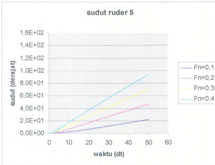
Gambar 3.10. Perbandingan sudut yawing kapal pada defleksi rudder 5^{\circ}
