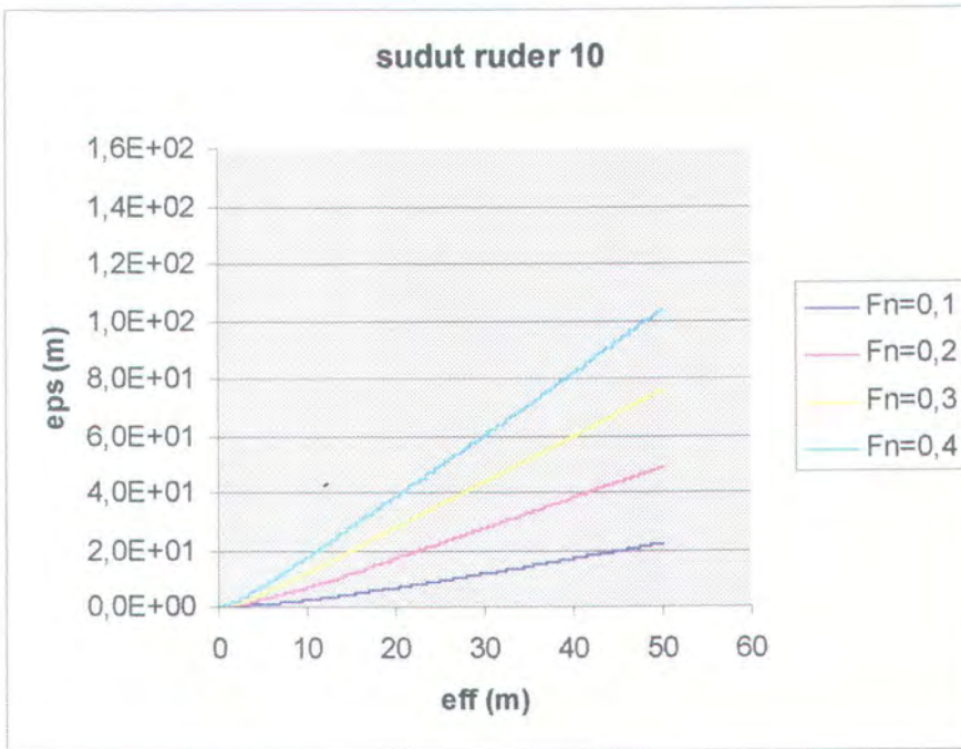
Gambar 3.11. Perbandingan sudut yawing kapal pada defleksi ruder 10^0
