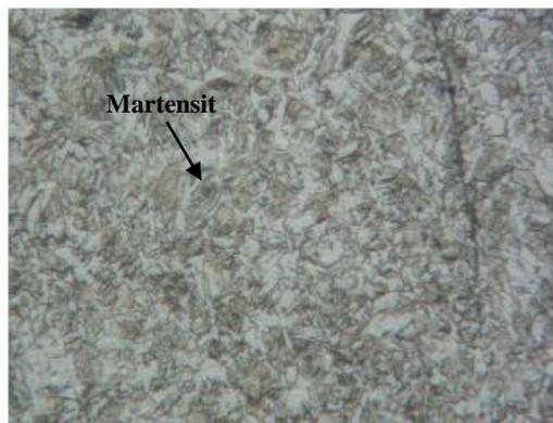
**Gambar 2.12** Struktur mikro baja karbon rendah perlakuan hardening perbesaran 500x (Purnomo, 2010)
