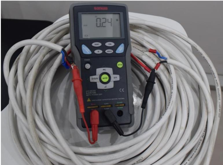
**Gambar 3. 3** Impedansi Saluran 0,24 Ω
