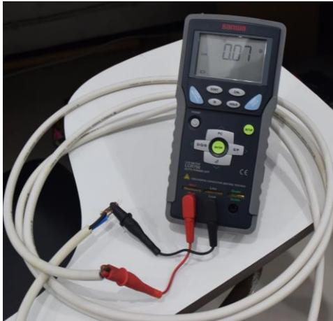
**Gambar 3. 4** Impedansi Saluran 0.07  $\Omega$
