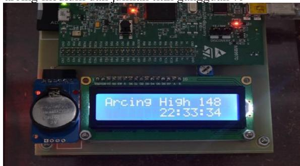
**Gambar 4. 15** Alat pendeteksi arcing mendeteksi adanya arcing high dan jumlah titik gangguan 148
