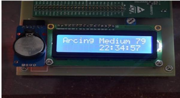
**Gambar 4. 14** Alat pendeteksi arcing mendeteksi adanya arcing medium dan jumlah titik gangguan 79
