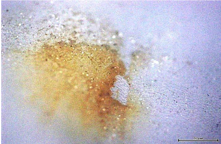
Gambar permukaan coating PTFE pada 450 ppm NaCl (50°C)
