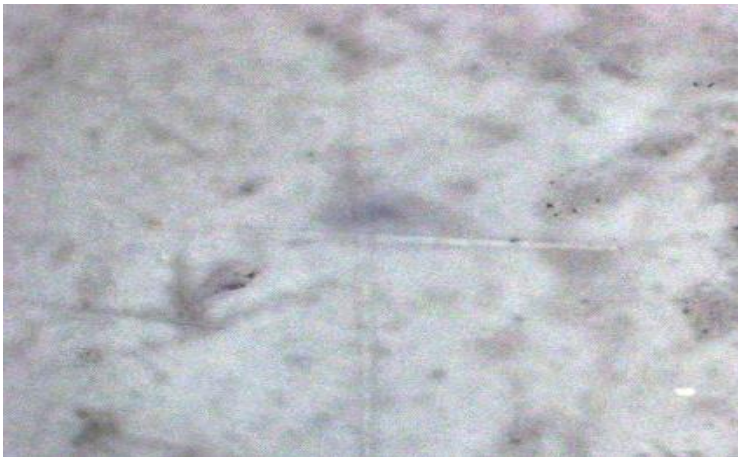
Gambar permukaan coating PTFE pada 150 ppm NaCl (70°C)
