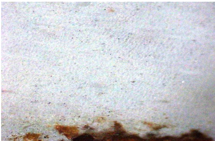
Gambar permukaan coating PTFE pada 450 ppm NaCl (70°C)
