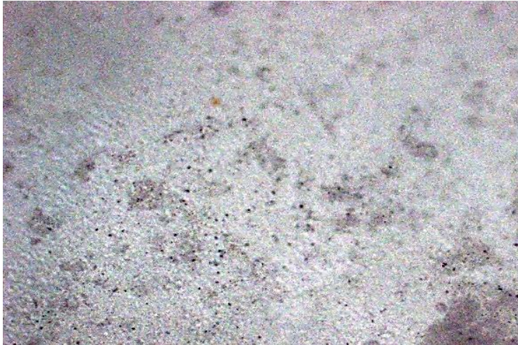
Gambar permukaan coating PTFE pada 0 ppm NaCl (60°C)
