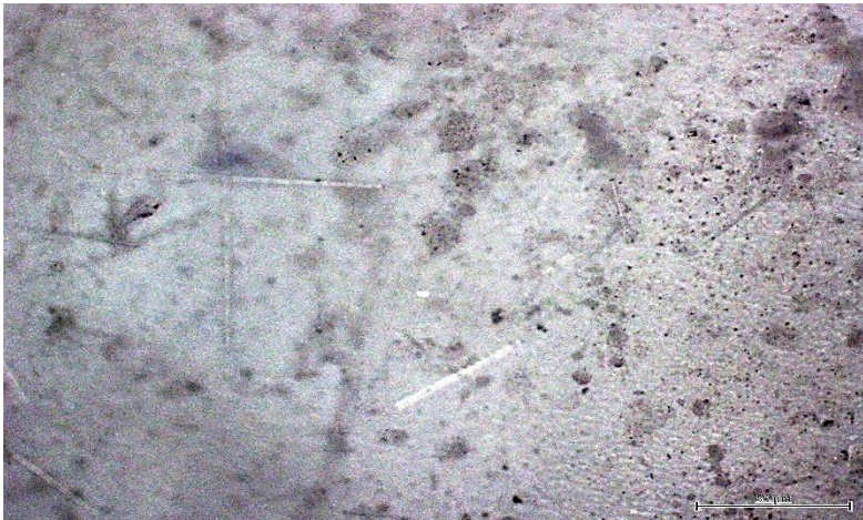
Gambar permukaan coating PTFE pada 150 ppm NaCl (50°C)
