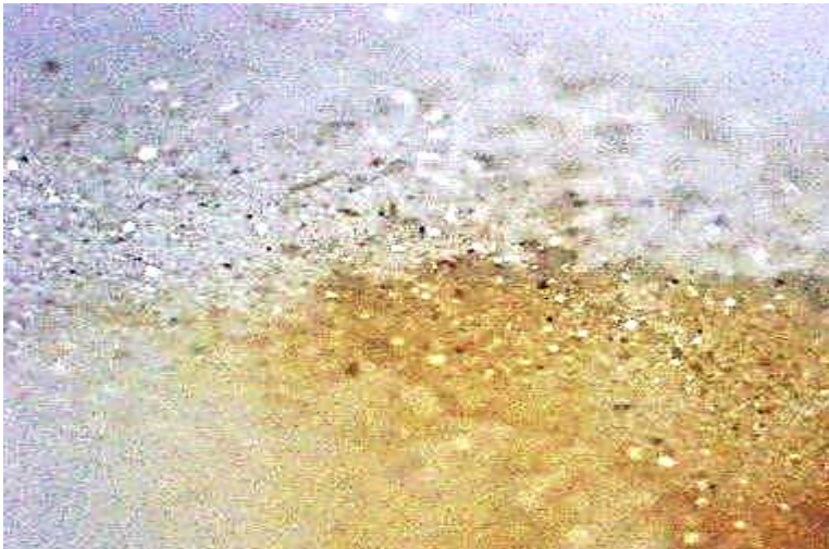
Gambar permukaan coating PTFE pada 450 ppm NaCl (60°C)
