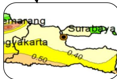
Gambar 2.3 Peta Respons Spektra Percepatan 0,2 detik (Ss) di bantuan dasar (Sa) untuk Probabilitas Terlampaui 10% dalam 50 Tahun
