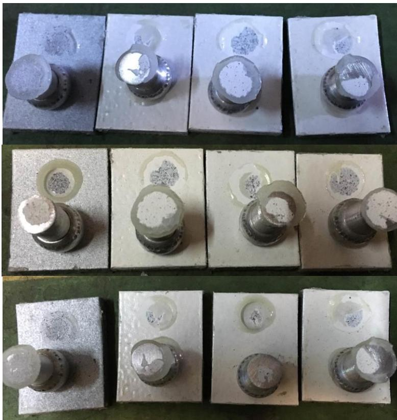
**Gambar B.2** Pengamatan Visual Hasil Uji Daya Lekat dengan Perbedaan Jumlah Layer Cat Setelah Immers
