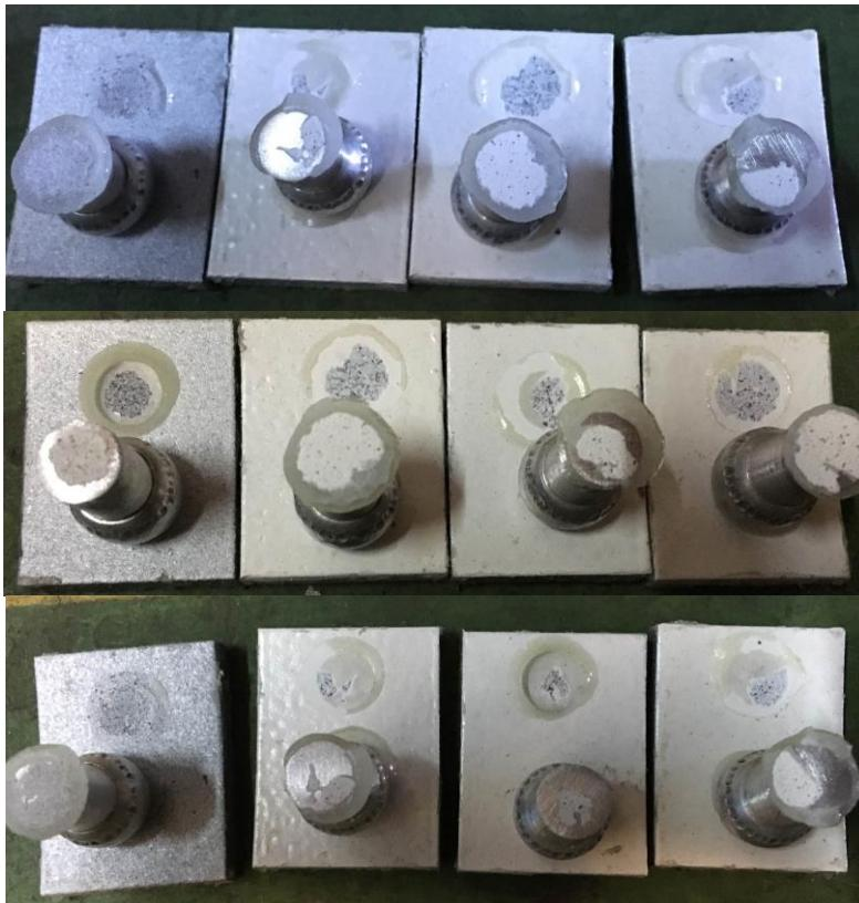
**Gambar 4.3** Hasil Pengujian Daya Lekat dan Pengamatan Visual pada sampel setelah dilakukan *immersion* selama 20 hari
