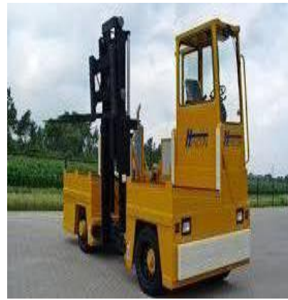
Gambar 2.10 : Side Loader Sumber : www.hencon.nl
