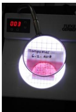
Gambar 3. 8 Menghitung Total Coliform dengan Colony Counter
