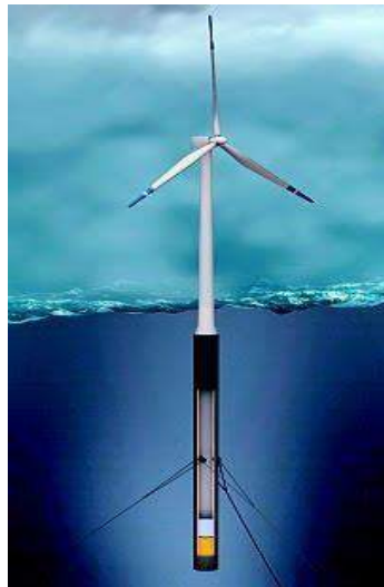
Gambar 2. 9 Sistem tambat OWT tipe taut (Bagbanci, 2011)
