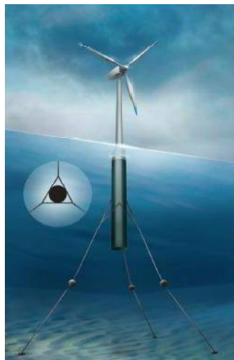
Gambar 2. 8 Sistem tambat OWT tipe catenary (Karimirad, 2011)
