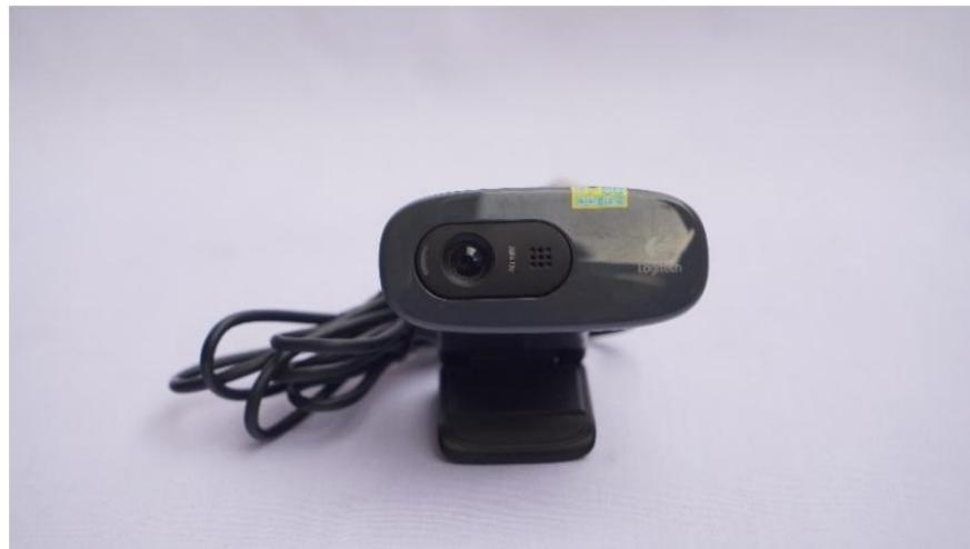
**Gambar 4.18.** Webcam Logitech c270 dengan lensa *fixed focus*.
