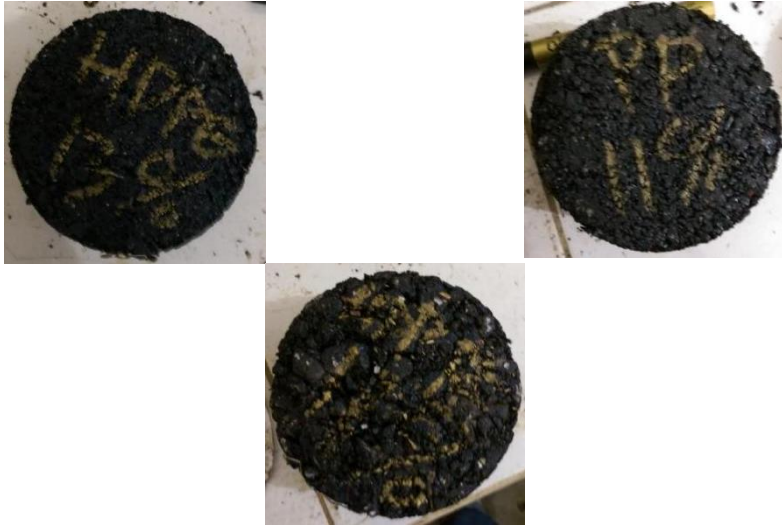
Gambar IV.2 Beberapa sampel hasil pencampuran Aspal Beton dengan Plastik
