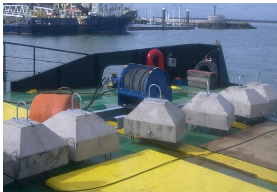
Gambar 2. 14 Bentuk-bentuk dari Concrete block anchor (Google-Images)
