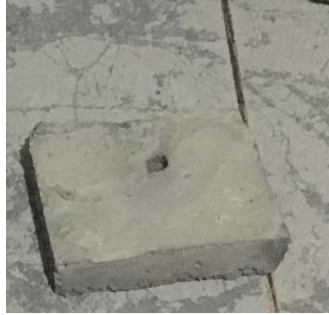
Gambar 3. 16 Desain pengujian model Concrete block anchor dengan berat 500 gram
