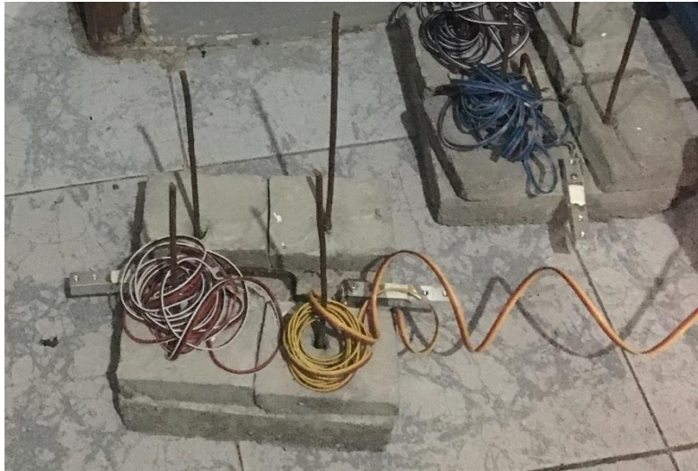
Gambar 3. 12 Desain pengujian model Concrete block anchor yang tertancap sensor Load Cell
