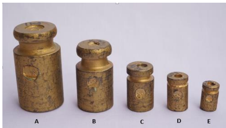
Gambar 4.5 Beban kalibrasi 1000 g (A), 500 g (B), 200 g (C), 100 g (D), dan 50 g (E)
