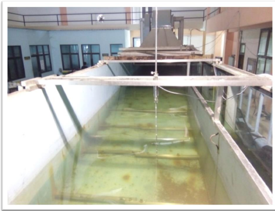
Gambar 3.4 Wave flume tempat model uji ditempatkan
