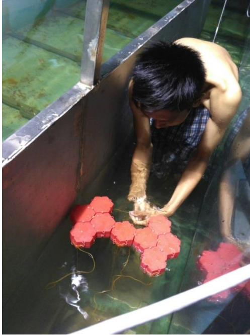
Pemasangan mooring pada model hexagonal floating breakwater
