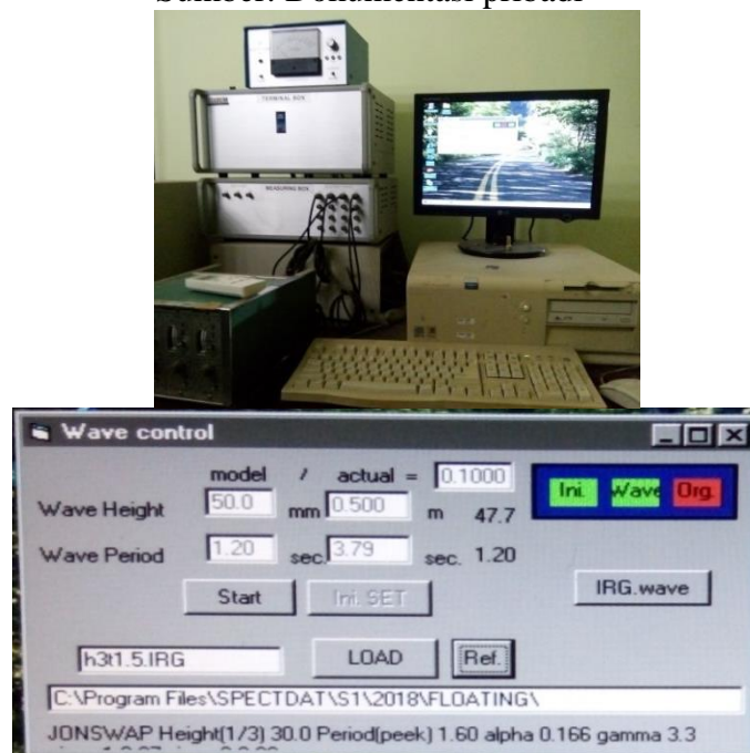
Gambar 3.8 Tampilan pengaturan wave generator
