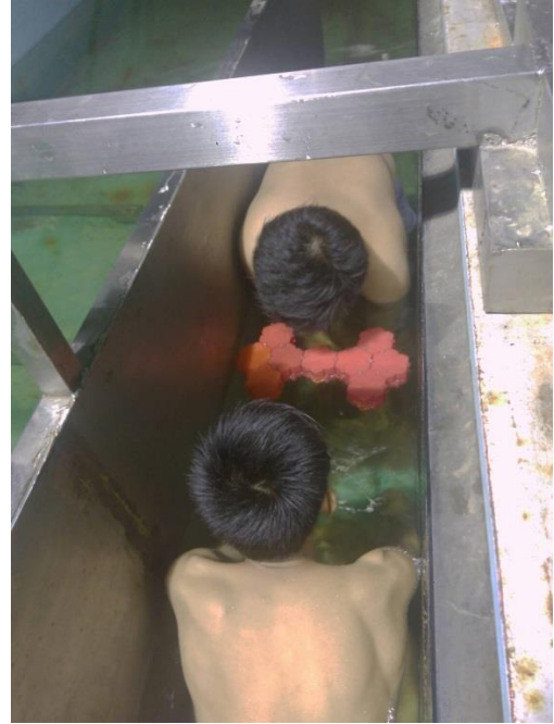
Pemasangan mooring pada model hexagonal floating breakwater
