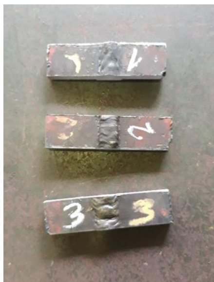
Gambar 3.8 Spesimen Uji Kekerasan dan Metalografi
