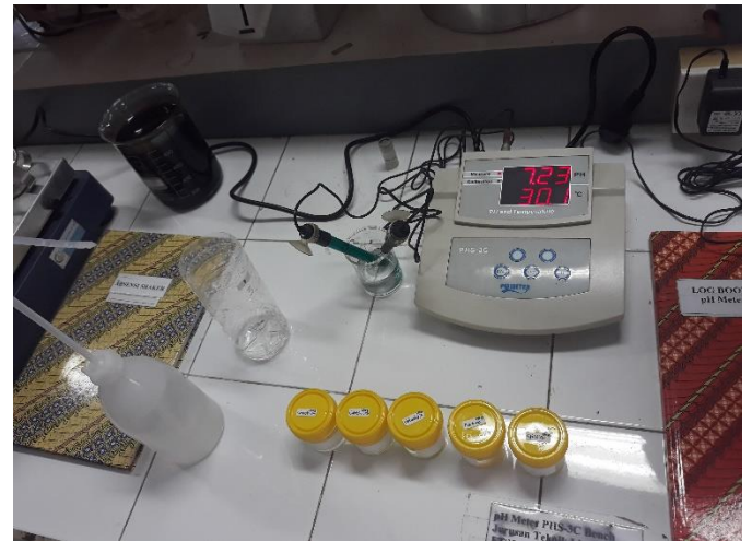
uji pH dan suhu menggunakan pH meter
