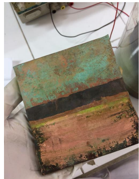
kondisi anoda tembaga setelah eksperimen
