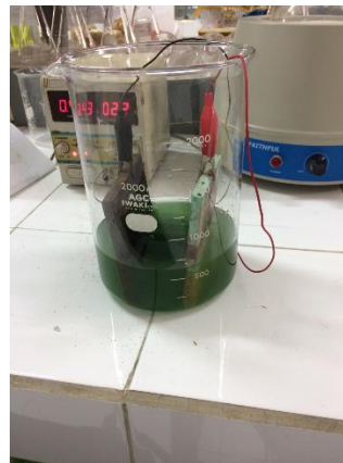
Gambar 4. 24 uji ketahanan Spirulina platensis dengan variasi waktu dan arus listrik 1 A
