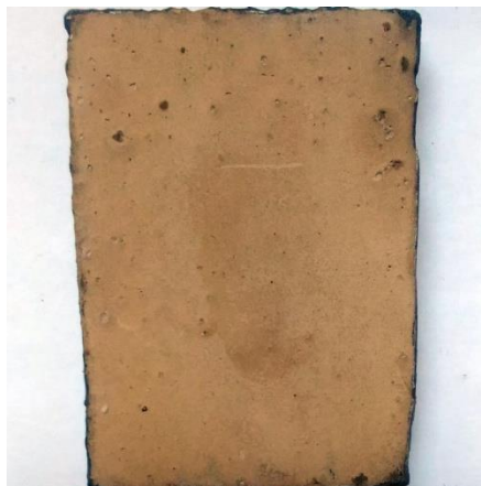
Gambar 4.12 Hasil Pelapisan Geopolimer Dan Nanosilika Dengan Variasi 3% Nanosilika
