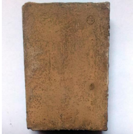
Gambar 4.11 Hasil Pelapisan Geopolimer Dan Nanosilika Dengan Variasi 2% Nanosilika
