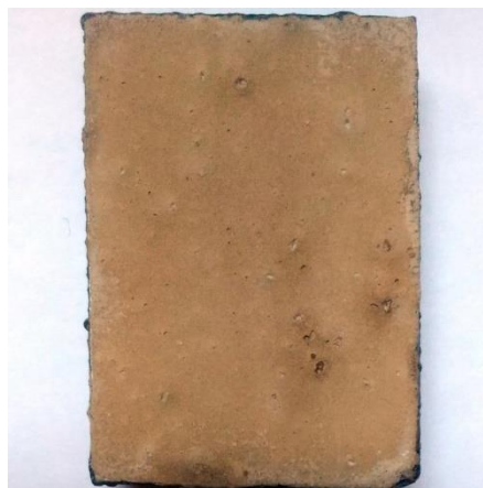
Gambar 4.10 Hasil Pelapisan Geopolimer Dan Nanosilika Dengan Variasi 1% Nanosilika
