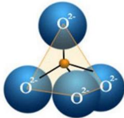
Gambar 2.2 Struktur Silika Tetrahedral (Surdia et al , 2000)
