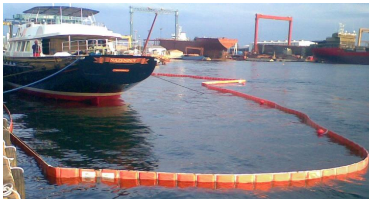
Gambar 3 Fence Boom (Mavi Deniz Co., tanpa tahun)
